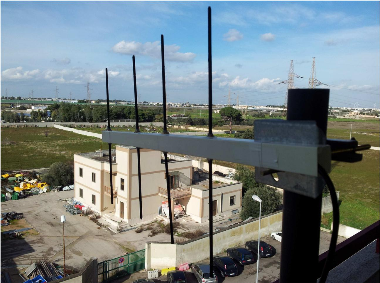
Ora una piccola curiosità : mentre assemblavo l'antenna ho provato il ROS usando solo il riflettore e naturalmente il dipolo, riscontrando una lettura di 1:5, aggiungendo il primo direttore la lettura del ROS è diminuita, quando infine ho aggiunto il secondo ed ultimo direttore il ROS è sceso a 1:1.
