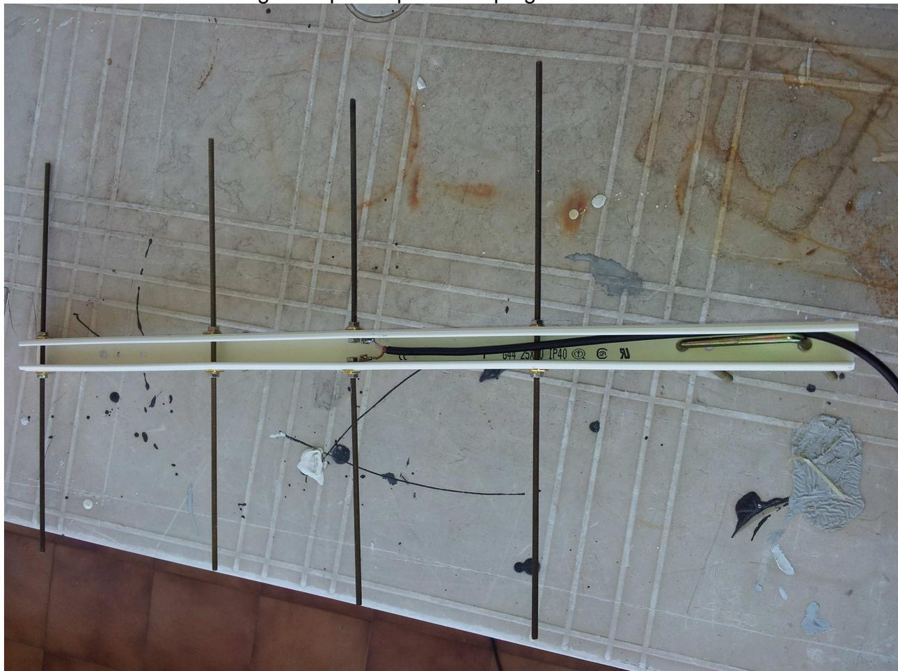
Veniamo alle misure il riflettore è lungo 34 cm. ed è costituito da una barra filettata da 4mm. in ottone. Il Radiatore è sempre realizzato con barra filettata da 4mm ma costituito da due sezioni da 16 cm. ciascuna, i due direttori sono lunghi 30 cm. l'uno, sempre realizzati con barra filettata da 4mm in ottone.
